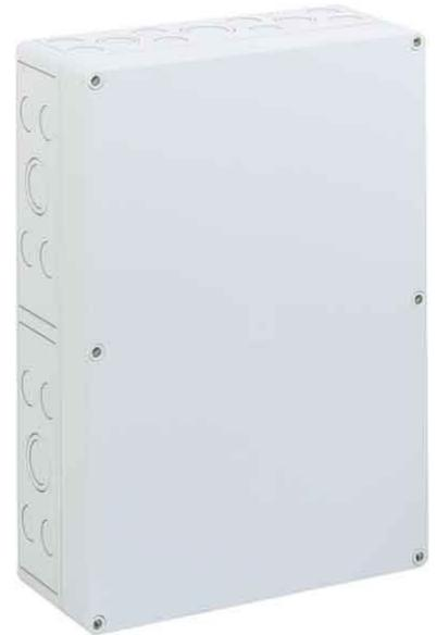
Spelsberg Leergehäuse TK PC 3625-11-m PV Höhe 360mm, Breite 254mm, Tiefe 111mm, RAL-Nummer 7035, Anbaumöglichkeit, Werkstoff des Gehäuses Kunststoff, Oberfläche sonstige, Schutzart (IP) IP66, Art des Deckels geschlossen, Leergehäuse für Spannungen bis  $U_i=690$  V, Kasten und Deckel aus glasfaserverstärktem Polycarbonat, lichtgrau, mit metrischen Vorprägungen
