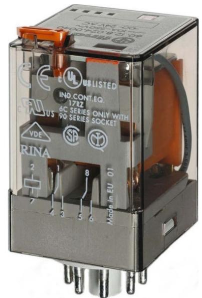
Finder Strom-Steckrelais 60.12.4.102.0040 Ausführung des elektrischen Anschlusses Steckanschluss, Spannungsart zur Betätigung DC, Antrieb, Polung ungepolt, Schaltverhalten des Antriebs monostabil, Anzahl der Kontakte als Öffner 0, Anzahl der Kontakte als Schließ 0, Anzahl der Kontakte als Wechsler 2, Breite 32,5mm, Höhe 66,8mm, Tiefe 36,4mm, Nennstrom 10A, Stromrelais zur Überwachung von Signallampen und DC-Motorwicklungen, 1 A
