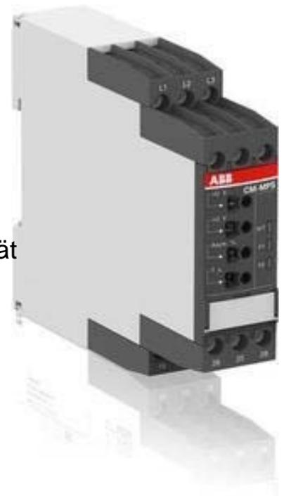
ABB Stotz S&J 3-Phasenüberwachungsrelais 2W 30s, 3x300-500VAC CM-MPS.43P Ausführung des elektrischen Anschlusses Federzuganschluss, Bemessungssteuerspeisespannung  $U_s$  bei AC 50 Hz 300 ...
