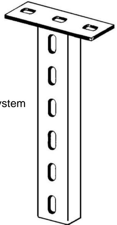
Niedax Hängestiel HUF 50/300 K Länge 300mm, Profilbreite 50mm, Ausführung U-Profil, Werkstoff Stahl, Werkstoffgüte sonstige, Oberfläche tauchfeuerverzinkt und beschichtet, Farbe ohne, Hängestiel, mit angeschweißter Kopfplatte, für Ausleger KTUL...
