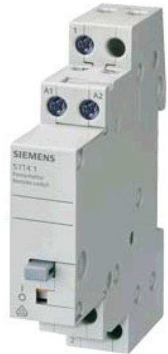
Siemens Indus.Sector Fernschalter 2S,16A,12VDC 5TT4112-3 Funktion mechanisch Schalter, Montageart DIN-Schiene, Breite in Teilungseinheiten 1, Einbautiefe 70mm, Anzahl der Schließer 2, Anzahl der Öffner 0, Anzahl der Wechsler 0, Steuerspannung 1 9,6 ...
