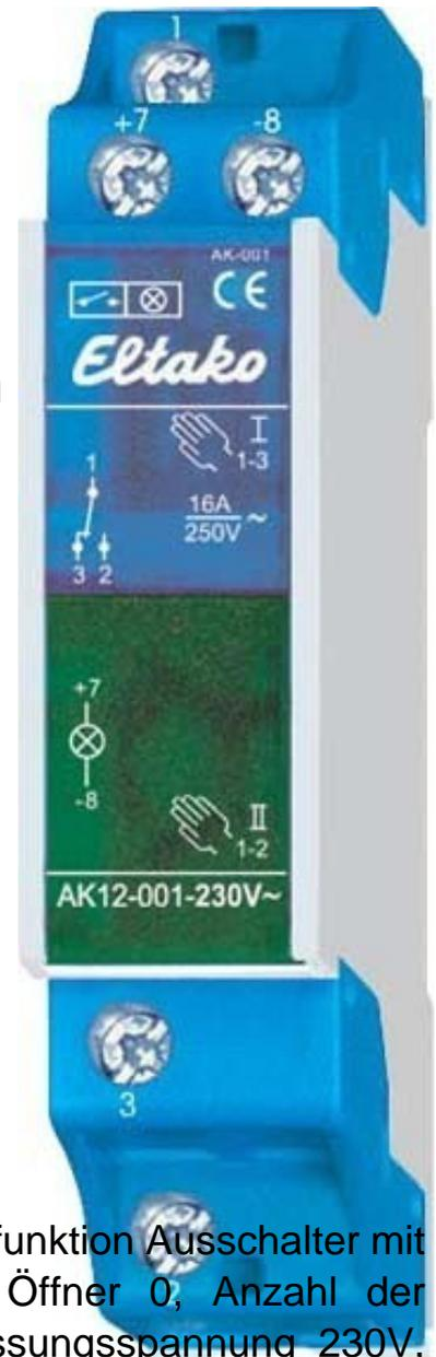
Eltako Kontrollschalter 230 V AK12-001-230V-gelb Schaltfunktion Ausschalter mit Kontrollleuchte, Anzahl der Schließer 0, Anzahl der Öffner 0, Anzahl der Wechsler 1, Polzahl 1, Bemessungsstrom 16A, Bemessungsspannung 230V, Spannungsart AC, Mit Signallampe, Farbe der Kalotte gelb, Leuchtmittel LED, Lampensockel sonstige, Breite in Teilungseinheiten 1, Einbautiefe 55mm, Ausschalter mit einer Kontrollleuchte gelb und 1 Wechsler.
