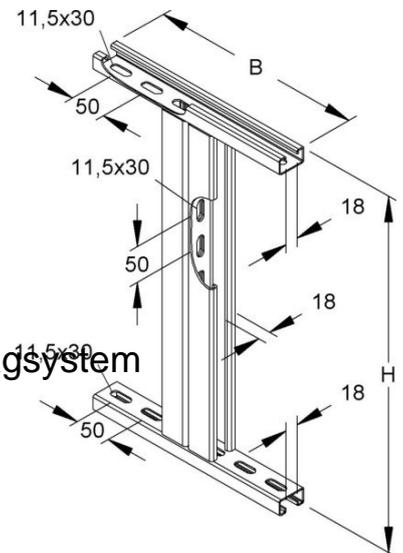
Niadax Bodenstütze symetrisch RSST 500.500 Geeignet für Rinnen-/Leiterbreite 500mm, Höhe 500mm, Werkstoff Stahl, Werkstoffgüte sonstige, Oberfläche tauchfeuerverzinkt, Farbe ohne, Ankerschiene horizontal Modell 2986 gelocht, Lochung 11,5x30 mm, Schlitzweite 18 mm, Ankerschiene vertikal Modell 2988 ungelocht, Schlitzweite 18 mm, symetrische Ausführung
