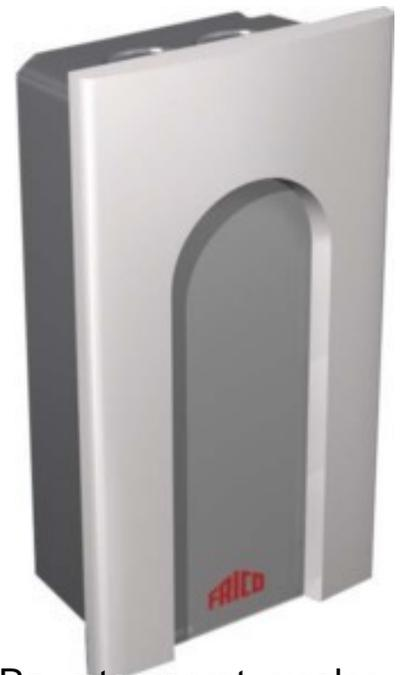
Kraemer&Kraus Raumtemperaturregler RTI 2 Ausführung Raumtemperaturregler, Nennspannung 230V, Schutzart (IP) IP44, elektronischer 2-Stufen-Thermostat für Thermozone Luftschleier, Regelbereich von +5 bis +35 Grad C
