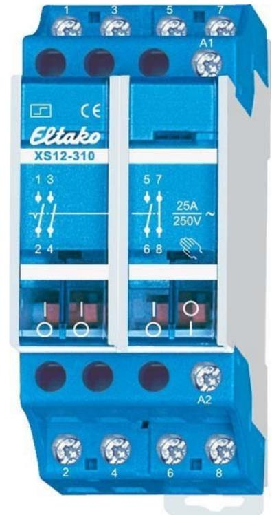
Eltako Stromstoßschalter 3S+1Ö 25A XS12-310-12V DC Funktion sonstige, Montageart DIN-Schiene, Breite in Teilungseinheiten 2, Einbautiefe 55mm, Anzahl der Schließer 3, Anzahl der Öffner 1, Anzahl der Wechsler 0, Steuerspannung 1 12 ...
