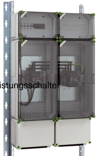
Spelsberg NA - Schutzgehäuse 3-polig, TN-C GNA 7316 Polzahl 3, Nennstrom 145A, Abschaltleistung nach IEC 947, Icu, 400 V 36kA, Nennspannung AC 50 Hz 415V, Überlastauslöser 145 ...
