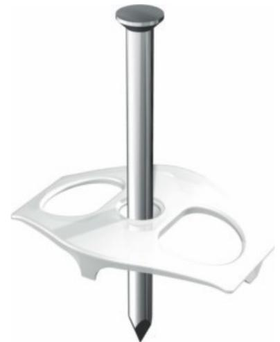
OBO Bettermann Vertr Nagel-Fix m.Nagel natur halog-frei 1996 70 Nagellänge 70mm, Nageldurchmesser 3,5mm, Anzahl der Leitungen NYM 3x1,5 2, Werkstoff Scheibe Kunststoff, Werkstoff Nagel Stahl, Oberfläche galvanisch/elektrolytisch verzinkt, Farbe natur, Mit Nagel, Zur Fixierung von Leitungen in Mauerschlitzen und auf Mauerwerk.
