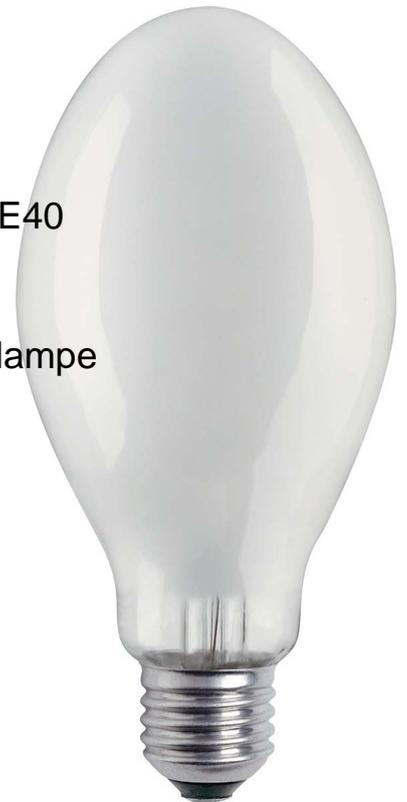
Osram Natriumdampf Lampe E40 NAV-E 100W SUPER 6Y Lampenleistung 100W, Lichtstrom 10400lm, Sockel E40, Farbwiedergabestufe 20-39 (Klasse 4), Farbtemperatur 2000K, Gesamtlänge 186mm, Durchmesser 75mm, Energieeffizienzklasse A+, Mittlere Nennlebensdauer 24000h,
