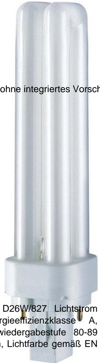
Osram Leuchtstofflampe G24D-3 warmweiß DULUX D26W/827 Lichtstrom 1800lm, Mittlere Nennlebensdauer 10000h, Energieeffizienzklasse A, Lampenleistung 26W, Sockel G24d-3 (2-pins), Farbwiedergabestufe 80-89 (Klasse 1B), Farbtemperatur 2700K, Durchmesser 12mm, Lichtfarbe gemäß EN 12464-1 warm
