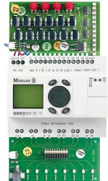
Eaton (Moeller) Ein-/ Ausgangssimulator 24V DC EASY800-DC-SIM Anzahl der digitalen Eingänge 11, Anzahl der digitalen Ausgänge 8, Anzahl der analogen Eingänge 1, Anzahl der analogen Ausgänge 1, Breite 108mm, Höhe 90mm, Tiefe 70mm,
