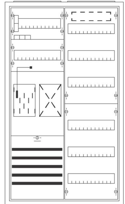
Striebel&John Schrank komplett 2/2A 1Z1V6 KS3211 Ausführung 1-stöckig, Anzahl der Zählerplätze 1, Anzahl der TSG-Plätze 0, Montageart Aufputz/Unterputz/teilversenkt, Werkstoff Stahlblech, Anzahl der Verteilerreihen 6, Anzahl der Felder 2, Schutzart (IP) IP31, Höhe 950mm, Breite 550mm, Tiefe 215mm,
