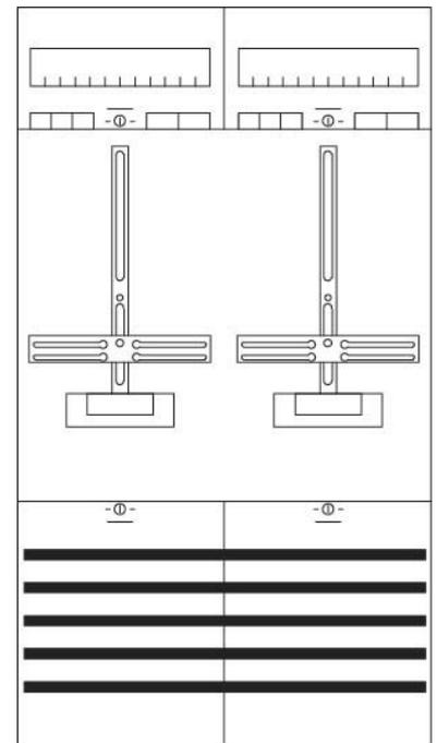
Striebel&John Zählerfeld BH2 2Z KA2232 Ausführung 1-stöckig, Anzahl der Zählerplätze 2, Anzahl der TSG-Plätze 0, Unterer Anschlussraum mit Sammelschiene 5-polig, Anzahl der Verteilerreihen 0, Breite 500mm, Höhe 900mm, Breite in Teilungseinheiten 24, Ausführung Deckel geschlossen mit Vorprägung, Anschlussraum 300mm,
