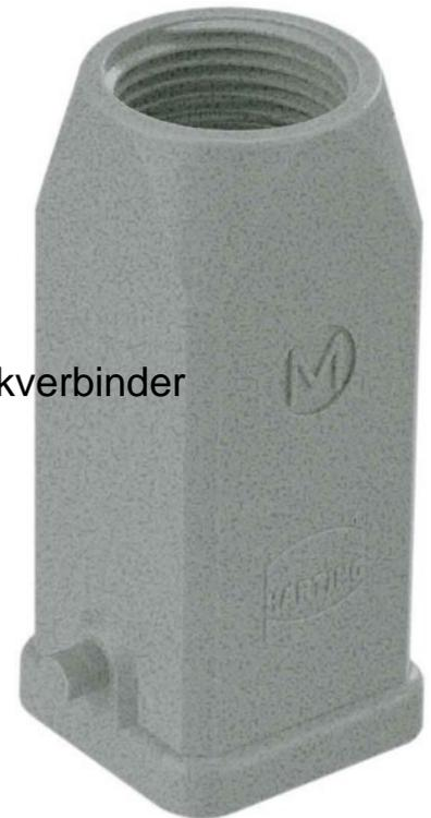
Harting Tüllengehäuse Metall HAN 3A-GG M20 19 20 003 1440 Form rechteckig, Länge 60mm, Höhe 28mm, Breite 33,4mm, Ausführung des Gehäuses Steckergehäuse, Anordnung der Kabelzuführung oben, Bügellage Unterteil, Werkstoff des Gehäuses Zink, Beschichtung Gehäuse pulverbeschichtet, Mit Verriegelungsvorrichtung, Art der Verriegelung Längsbügel, Betriebstemperatur -40 ...
