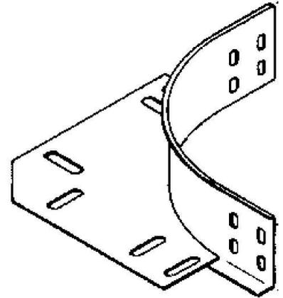
Niedax Anbaueck REK 60 Richtungsänderung horizontal, Abbiegung (Winkel) 90°, Innenradius 140mm, Kabelrinnenhöhe 60mm, Seitenlochung, Montagelochung im Boden, Ausführung integrierter Verbinder, Werkstoff Stahl, Werkstoffgüte sonstige, Oberfläche bandverzinkt, Farbe ohne, Zur Herstellung von Bögen und rechtwinkligen Abzweigen, passend zu allen Kabelrinnenbreiten, mit integriertem Stoßstellenverbinder, Verbindungsschrauben im Lieferumfang enthalten
