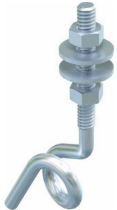
OBO Bettermann Vertr Deckenhaken M6x70 948 TG6 Werkstoff Stahl, Oberfläche galvanisch/elektrolytisch verzinkt, Ösen-Innendurchmesser 13mm, Schaftdurchmesser 6mm, Gesamtlänge 70mm, Gewindelänge 46mm, Bruchlast 1000N, Deckenhaken in stark gewundener Ausführung.
