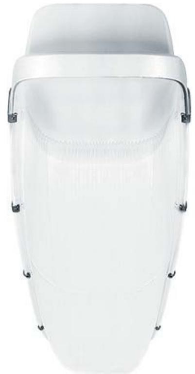
Zumtobel Licht Feuchtraumwannenleuchte 2/58W T26 EVG SC2V2A SCUBA CH #42174445 Leuchtmittel Leuchtstofflampe D=26 mm, Fassung G13, Geeignet für Leuchtmittellanzahl 2, Lampenleistung 58W, Betriebsgerät EVG Standard, Nennspannung 220 ...
