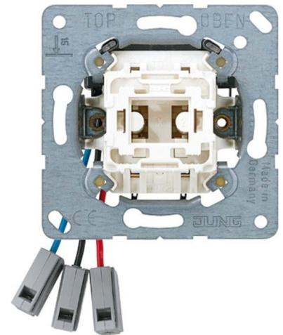
Jung Taster für Hotel-Display 531 EU LED RG 230 Zusammenstellung Basiselement, Ausführung Einzeltaster, Bedienungsart Wippe, Kontakte 1 Schließer, Montageart Unterputz, Befestigungsart Krallen-/Schraubbefestigung, Halogenfrei, Nennspannung 250V, Bemessungsstrom 10A, Taster, 10 AX, 250 V ~, für Hotel-Display DND / MUR, Außenstelle, N-Leiter erforderlich, mit Federklemmen für starre Leiter bis 2,5 mm<sup>2</sup>, Verbindungsklemmen nach DIN VDE 0632 (EN 60 669)
