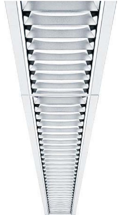
Abdeckung weiß, Werkstoff des Rasters sonstige, Länge 1498mm, Breite 114mm, Höhe/Tiefe 85mm, Schutzklasse I, Schutzart (IP) IP20, Einbauleuchte mit Comfortraster 1/49W für T16, mit elektronisches Vorschaltgerät, Einbaugehäuse aus Stahlblech weiss thermolackiert, integrierte Abluftöffnungen, 3-polige Steckverbindungsklemme, Bivergenzspiegelraster aus mattsilber eloxiertem Reinaluminium, mit V-förmig gebogenen, für höhere Effizienz oben geschlossenen Querlamellen, Leuchte halogenfrei verdrahtet.
