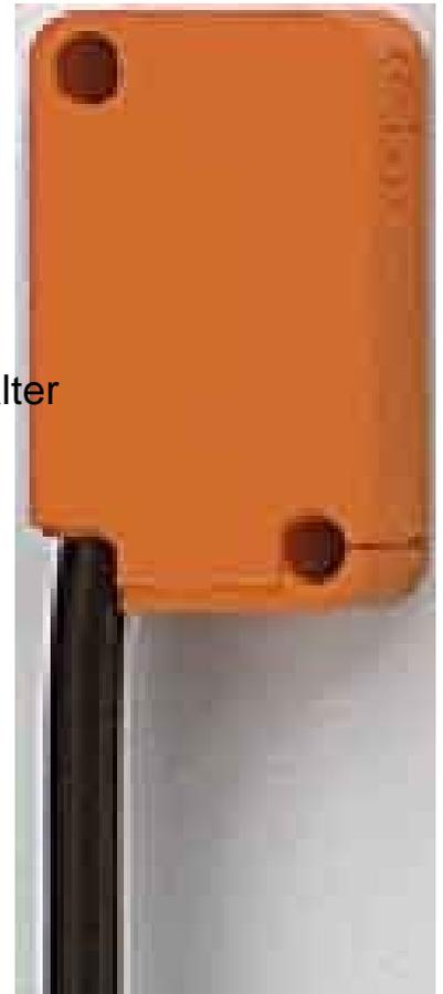
Ifm Electronic Sensor,ind.,27.8x16x10.3 DC,pnp,no,sn=2mm,b IS5001 Breite des Sensors 10,2mm, Höhe des Sensors 27,8mm, Länge des Sensors 16mm, Schaltabstand 2mm, Ausführung des Schaltausgangs PNP, Gehäusebauform Quader, Max.
