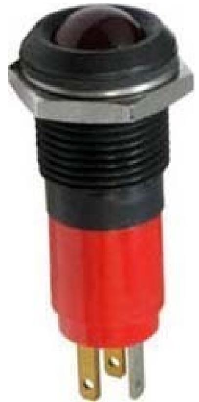
LED-Signallampe 10mm 24VAC/DC rot sw/chr 38492 Farbe rot, Nennspannung 24V, Spannungsart AC/DC, Nennstrom 17mA, Durchmesser 16mm, Länge 43,5mm, Standardreflektor mit integriertem Vorwiderstand und Lampentestanschluss IP67, Einbau-Durchmesser 10mm für Schraubbefestigung mit matted Leuchfläche für optimalen Ein/Aus-Kontrast und Spritzwasser geschützten Einbau.
