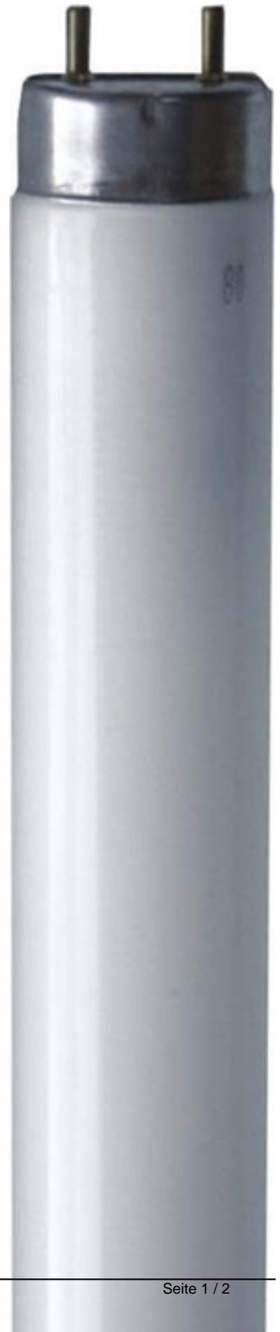
Leuchtstofflampe T8/T12 38x1200mm 68387 Lichtstrom 3200lm, Mittlere Nennlebensdauer 20000h, Lampenleistung 36W, Sockel G13, Farbwiedergabestufe 80-89 (Klasse 1B), Farbtemperatur 3000K, Lampenform Stab, Lampenlichtausbeute 88,9lm/W, Lichtfarbe 830, Lichtfarbe gemäß EN 12464-1 warm
