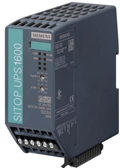
Siemens Indus.Sector DC-USV mit Batterien 24VDC,10A,USB 6EP4134-3AB00-1AY0 Eingangsspannung 24V, Ausgangsscheinleistung 240VA, Höhe 125mm, Breite 50mm, Tiefe 125mm, Gewicht 0,4kg, Zur Überbrückung von längeren Netzausfällen bis in den Stundenbereich lassen sich 24-V-SITOP Netzgeräte mit einer unterbrechungsfreien DC-Stromversorgung (DC-USV) mit Batteriemodulen erweitern.
