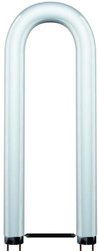
Leuchtstofflampe U-Form T8 26x607mm 68801 Lichtstrom 3350lm, Mittlere Nennlebensdauer 5000h, Energieeffizienzklasse A, Lampenleistung 36W, Sockel 2G13, Farbwiedergabestufe 80-89 (Klasse 1B), Farbtemperatur 3000K, Lampenform U, Lampenlichtausbeute 93,1lm/W, Lichtfarbe 830, Lichtfarbe gemäß EN 12464-1 warm
