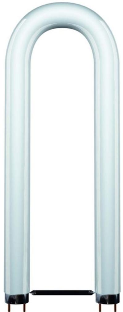
Leuchtstofflampe U-Form T8 26x765mm 68802 Lichtstrom 5250lm, Mittlere Nennlebensdauer 5000h, Energieeffizienzklasse A, Lampenleistung 58W, Sockel 2G13, Farbwiedergabestufe 80-89 (Klasse 1B), Farbtemperatur 3000K, Lampenform U, Lampenlichtausbeute 90,5lm/W, Lichtfarbe 830, Lichtfarbe gemäß EN 12464-1 warm
