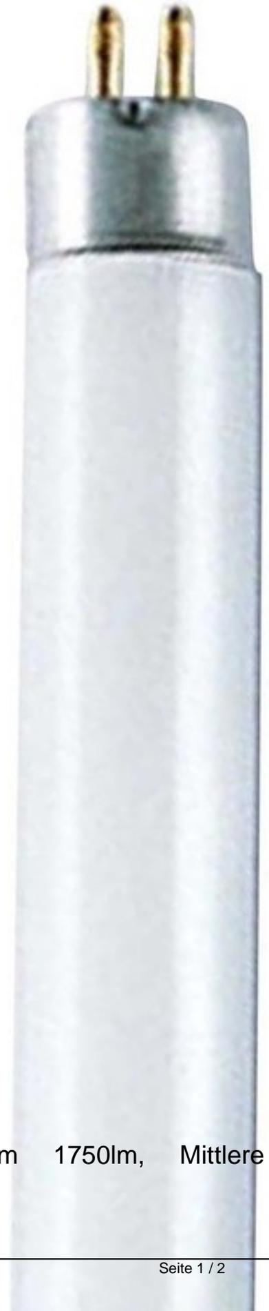
Nennlebensdauer 24000h, Lampenleistung 24W, Sockel G5, Farbwiedergabestufe 80-89 (Klasse 1B), Farbtemperatur 4000K, Lampenform Stab, Lichtfarbe 840, Lichtfarbe gemäß EN 12464-1 neutral 3300 bis 5300 K, Rohrdurchmesser 16mm, Länge 549mm, Farbe ohne, Anwendung allgemein,
