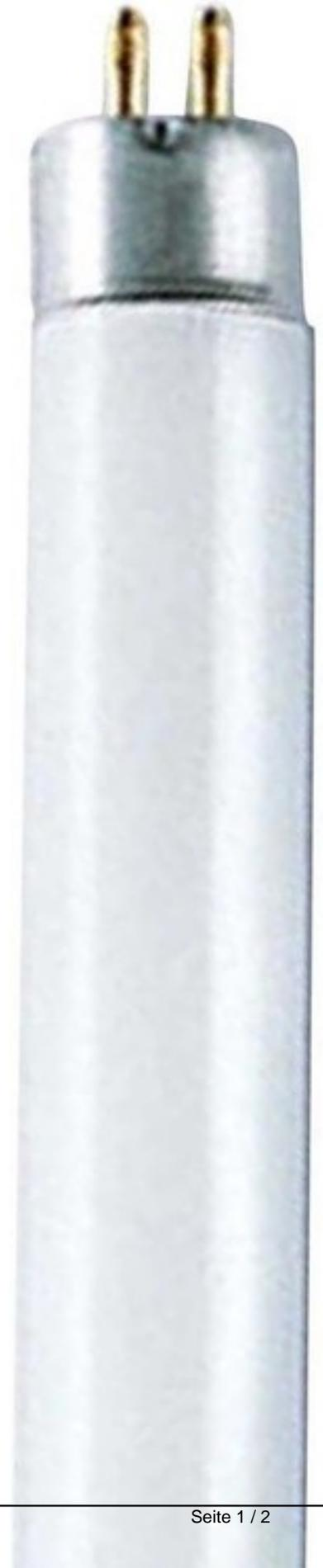
Leuchtstofflampe T5 16x1149mm 68229 Lichtstrom 2400lm, Mittlere Nennlebensdauer 24000h, Lampenleistung 28W, Sockel G5, Farbwiedergabestufe 80-89 (Klasse 1B), Farbtemperatur 6500K, Lampenform Stab, Lampenlichtausbeute 86lm/W, Lichtfarbe 865, Lichtfarbe gemäß EN 12464-1 kühl >5300 K, Rohrdurchmesser 16mm, Länge 1149mm, Farbe ohne, Anwendung allgemein,
