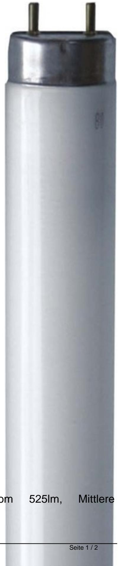
Nennlebensdauer 14000h, Lampenleistung 14W, Sockel G13, Farbwiedergabestufe 40-59 (Klasse 3), Farbtemperatur 10000K, Lampenform Stab, Lichtfarbe gemäß EN 12464-1 kühl >5300 K, Rohrdurchmesser 26mm, Länge 361mm, Ausstrahlungswinkel 120°, Farbe sonstige, Anwendung sonstige,
