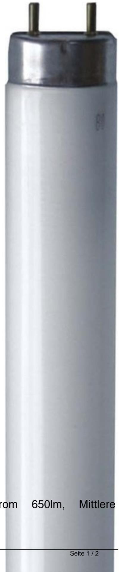
Nennlebensdauer 14000h, Lampenleistung 14W, Sockel G13, Farbwiedergabestufe 70-79 (Klasse 2A), Farbtemperatur 6500K, Lampenform Stab, Lichtfarbe 765, Lichtfarbe gemäß EN 12464-1 kühl >5300 K, Rohrdurchmesser 26mm, Länge 361mm, Farbe sonstige, Anwendung sonstige,
