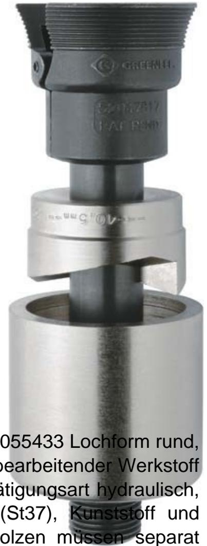
Klauke Spalt-Blechlocher-System Speed Punch PG 16 52055433 Lochform rund, Lochdurchmesser PG16, Lochdurchmesser 22,5mm, Zu bearbeitender Werkstoff Stahlblech ST 37, Ausführung Matrize und Stempel, Betätigungsart hydraulisch, Spaltlocher, Spalt-Blechlocher-System für Stahlblech (St37), Kunststoff und Aluminium bis zu 3,5 mm Stärke, Klammer und Zugbolzen müssen separat bestellt werden
