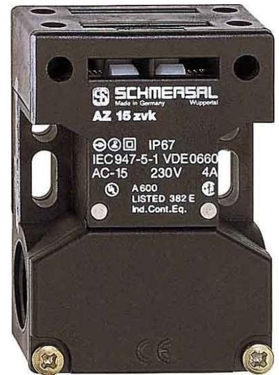
Schmersal Sicherheitsschalter AZ 15 ZVK-M16 Breite des Sensors 52mm, Höhe des Sensors 75mm, Länge des Sensors 30mm, Anzahl der Kontakte als Öffner 1, Anzahl der Kontakte als Schließ 0, Anzahl der Kontakte als Wechsler 0, Werkstoff des Gehäuses Kunststoff,
