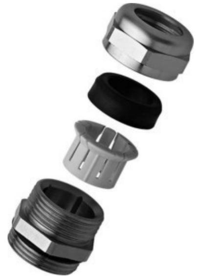
Schlemmer Kabelverschraubung WADI-TEC M 12 LANG Gewindeart metrisch, Gewindenenngröße metrisch/PG 12, Gewindesteigung 1,5mm, Gewindelänge 13mm, Schlüsselweite 14mm, Für Kabeldurchmesser 3 ...
