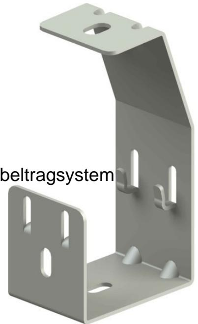
Legrand (Cablofil) Wand- und Deckenbügel SF 50 V4A Länge 50mm, Breite 50mm, Höhe 135mm, Ausführung Deckenbügel, Werkstoff sonstige, Werkstoffgüte rost- und säurebeständiger Stahl, Oberfläche sonstige, Farbe ohne,
