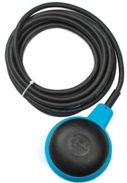
Finder Schwimmerschalter 1W, 20A, 5m 72.A1.0.000.0500 Polzahl 1, Ausführung Schalter im Schwimmer, Ausführung der Schaltfunktion Wechsler, Bemessungsbetriebsspannung U<sub>e</sub> bei AC 250V, Schutzart (IP) IP68, Bemessungsstrom I<sub>n</sub> 20A, Schwimmerschalter mit 2 Kammern, für Tauchpumpen und gering verschmutztes Wasser, Kontakt 10 A (cos phi 1) bzw.
