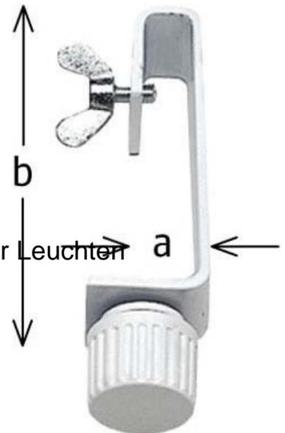
LTS Licht&Leuchten Leuchtenbefestigung 17mm L 17 si Art des Zubehörs Befestigungssatz, Farbe Silber, Werkstoff Stahl, Holzraster-Deckenbefestigung für Spannbereich 17 mm, a = 17 mm, b = 83 mm, aus Metall, Befestigung über Flügelschraube
