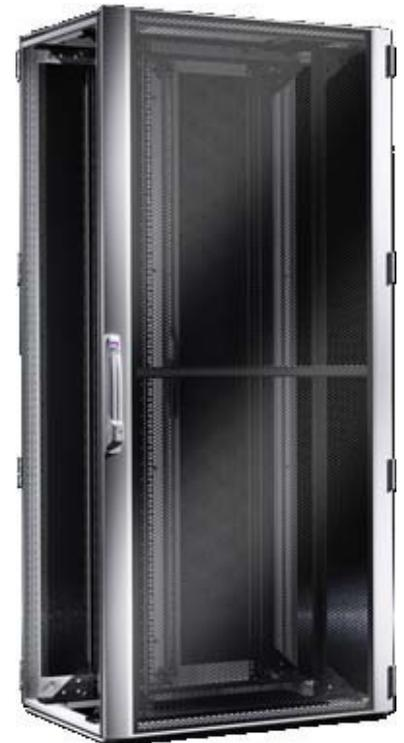
Rittal TS IT Rack 38HE BxHxT 800x1800x800 DK 5505.181 Montage-Ebene ohne, Ausführung der Profilschiene ohne, Anzahl der Türen 2, Art der Lüftung passiv, Breite 800mm, Höhe 1800mm, Tiefe 800mm, Rastermaß sonstige, Anzahl der Höheneinheiten (HE) 0, Mit Dachblech, Mit Fronttür, Mit rückseitiger Tür, Werkstoff Aluminium, Ausführung der Oberfläche pulverbeschichtet, Farbe grau,
