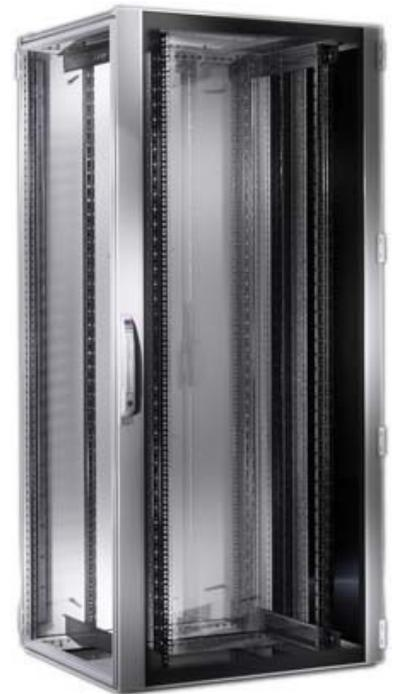
Rittal TS IT Rack 42HE BxHxT 600x2000x600 DK 5529.120 Montage-Ebene ohne, Ausführung der Profilschiene ohne, Anzahl der Türen 2, Art der Lüftung passiv, Breite 600mm, Höhe 2000mm, Tiefe 600mm, Rastermaß sonstige, Anzahl der Höheneinheiten (HE) 0, Mit Fronttür, Mit rückseitiger Tür, Werkstoff Aluminium, Ausführung der Oberfläche pulverbeschichtet, Farbe grau,
