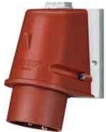
Mennekes Wandstecker TA 32A,5p,6h,400V,IP44 804 IEC-Stromstärke 32A, Polzahl 5, Spannung nach EN 60309-2 400 V (50+60 Hz) rot, Uhrzeit-Stellung 6h, Kennfarbe rot, Schutzart (IP) IP44, Anschlussstechnik Schraubklemme, Bauform Wandgerätestecker (AP), Steckrichtung rechtwinklig, Werkstoff Kunststoff,
