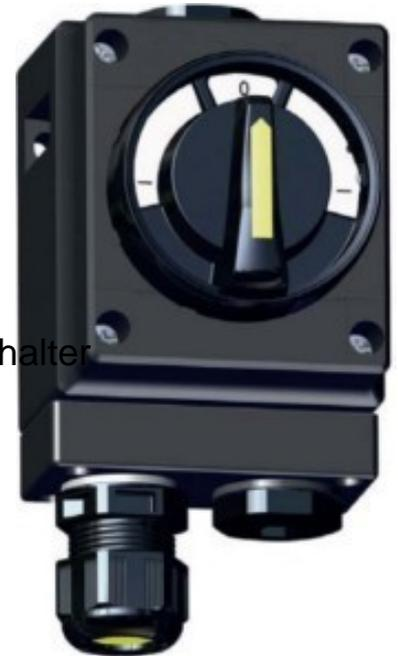
Stahl Wechselschalter 8040/11-V30-035-S Werkstoff des Gehäuses Kunststoff, Ausführung Wechselschalter, Polzahl 1, Für Ex-Zone Gas 1, 2, Für Ex-Zone Staub 21, 22, Zum Schalten von Beleuchtungsanlagen, eindeutige Anzeige der Schaltstellung durch 90°-Schalterstellung, mit fluoreszierendem Drehgriff, Umgebungstemperatur: -60...60°C, IP66 gemäß IEC/EN 60529, Bemessungsbetriebsspannung 690VAC, 220VDC
