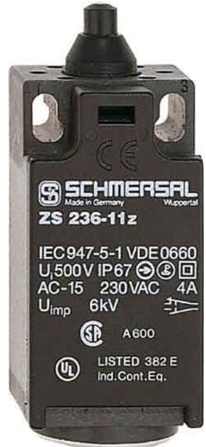
Schmersal Positionsschalter 1S,1Ö,Sprungschaltun ZS 236-11z-M20 Breite des Sensors 30mm, Höhe des Sensors 70,5mm, Schaltfunktion Sprungschaltglied, Anzahl der Kontakte als Öffner 1, Anzahl der Kontakte als Schließer 1, Anzahl der Kontakte als Wechsler 0, Werkstoff des Gehäuses Kunststoff, Ausführung des Betätigungselements Kuppenstößel,
