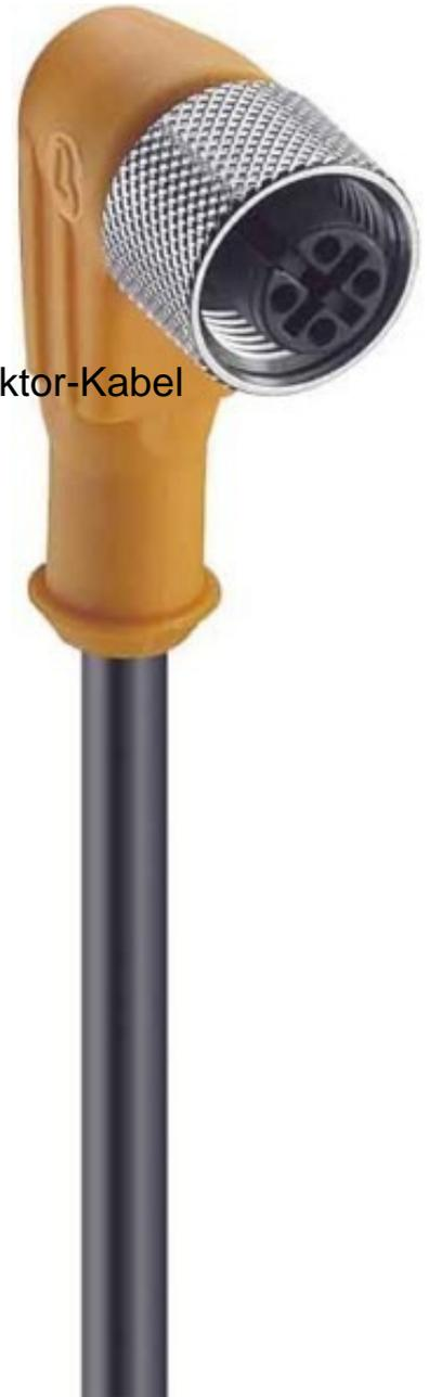
Belden Kupplung m.Schraubver.,gew 4pol.,M12,5m Kab.PUR RKWT 4-225/5m
