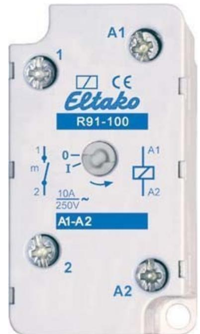
Eltako Schaltrelais f.EB/AP 1S 10A R91-100-8V Funktion sonstige, Montageart Aufputz, Breite in Teilungseinheiten 1,4, Einbautiefe 32mm, Anzahl der Schließer 1, Anzahl der Öffner 0, Anzahl der Wechsler 2, Steuerspannung 1 8 ...
