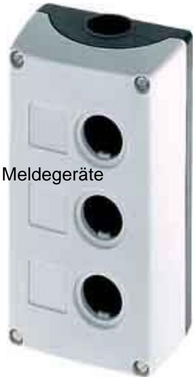
Siemens Indus.Sector Leergehäuse 22mm 3x Gr 3SB3803-0AA3 Anzahl der Befehlsstellen 3, Gehäusebauform Aufbaugehäuse, Werkstoff des Gehäuses Kunststoff, Durchmesser der Öffnungen 22mm, Farbe des Gehäuseoberteils grau, Schutzart (IP) IP65, Breite 85mm, Höhe 154mm, Tiefe 64mm, Gehäuse für 22mm, Programm Kunststoffausführung mit 3 Befehlsstellen, Oberteil grau
