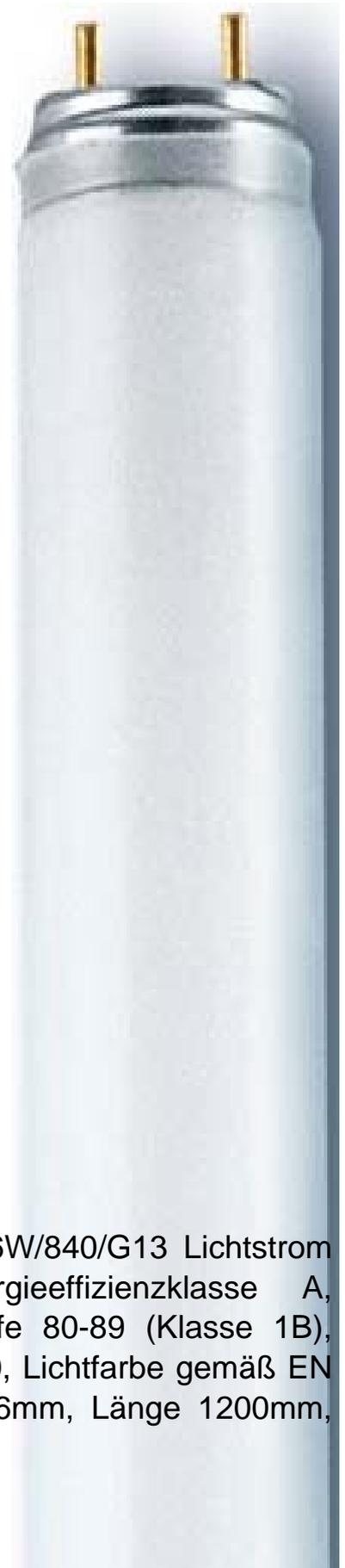
Radium Lampenwerk Leuchtstofflampe ws NL-T8/LR 36W/840/G13 Lichtstrom 3300lm, Mittlere Nennlebensdauer 50000h, Energieeffizienzklasse A, Lampenleistung 36W, Sockel G13, Farbwiedergabestufe 80-89 (Klasse 1B), Farbtemperatur 4000K, Lampenform Stab, Lichtfarbe 840, Lichtfarbe gemäß EN 12464-1 neutral 3300 bis 5300 K, Rohrdurchmesser 26mm, Länge 1200mm, Farbe sonstige, Anwendung allgemein,
