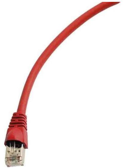
Telegärtner Patchkabel S/FTP 6A rt 10,0m 1x180Grd L00005A0029 Kabeltyp S/FTP, Kategorie 6A (IEC), Länge 10m, Steckverbindertyp Anschluss 1 RJ45 8(8), Steckverbindertyp Anschluss 2 RJ45 8(8), Mantel-Farbe rot, Knickschutztülle angespritzt, Rasthebelschutz, Farbe der Knickschutztülle rot, Ausführung flammwidrig, Halogenfrei, Kabelkonstruktion 4x2, AWG-Querschnitt 27, Pinbelegung 1:1, 360° Steckerabschirmung rundum geschlossen (geschirmte Kabel).
