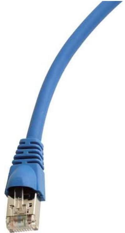
Telegärtner Patchkabel S/FTP 6A bl 0,5m 1x180Grd L0000A0075 Kabeltyp S/FTP, Kategorie 6A (IEC), Länge 0,5m, Steckverbindertyp Anschluss 1 RJ45 8(8), Steckverbindertyp Anschluss 2 RJ45 8(8), Mantel-Farbe blau, Knickschutztülle angespritzt, Rasthebelschutz, Farbe der Knickschutztülle blau, Ausführung flammwidrig, Halogenfrei, Kabelkonstruktion 4x2, AWG-Querschnitt 27, Pinbelegung 1:1, Anschlussfolge nach EIA/TIA 568B.
