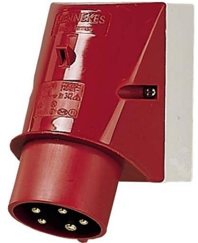
Mennekes Wandstecker 32A,5p,6h,400V,IP44 354 IEC-Stromstärke 32A, Polzahl 5, Spannung nach EN 60309-2 400 V (50+60 Hz) rot, Uhrzeit-Stellung 6h, Kennfarbe rot, Schutzart (IP) IP44, Anschlussstechnik Schraubklemme, Bauform Wandgerätestecker (AP), Steckrichtung rechtwinklig, Werkstoff Kunststoff,
